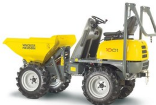
Думпер колесный Wacker Neuson грузоподъемностью 1000 кг
